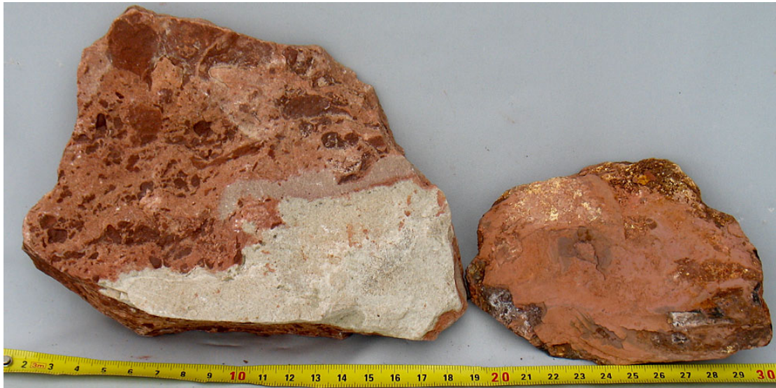
Bild 2. Vänster: Orsa sandsten från brottet Kallmora Höger: Bränd skiffer från alunverket i Garphyttan
